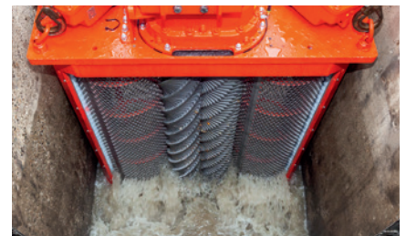
Die mächtigen Rotoren des XRippers verhindern Verstopfungen
