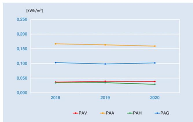
Abb. 25: Spezifischer Stromverbrauch Pumpanlagen 2018 - 2020
