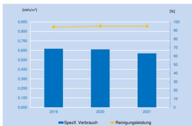
Abb. 16: Spezifischer Energieverbrauch bez. auf Kläranlagendurchfluss und Reinigungsleistung N (Stickstoff) - größere KA 2019 - 2021
