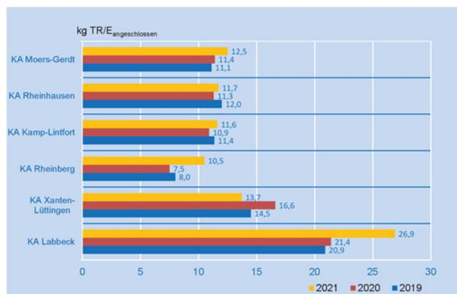
Abb. 21: Klärschlamm der kommunalen Kläranlagen bezogen auf die angeschlossenen Einwohnerwerte 2019 - 2021
